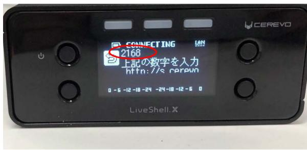
※本体に数字が表示されていない場合は 一度LANケーブルを抜いて再度挿入して下さい。
